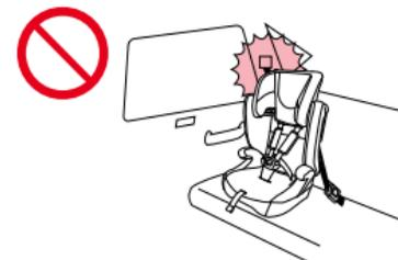
・ピラーなどに接触して、正しく取り付けできない座席。
