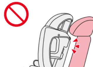
・車のヘッドレストが外せず、座席の背もたれとチャイルドシートが接触しない座席。
