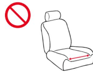
・座面のフラット面が極端に狭く正しく取り付けができない座席。（極端なバケットシート、スポーツ車、レース車、補助座席、幼児専用座席、市販座席に取り替えられた車両など）
