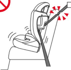
・シートベルトに損傷がある座席には取り付けない。
