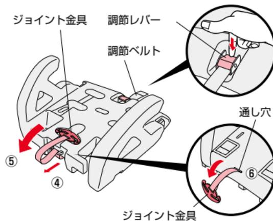
**アドバイス** 調節ベルトをシートカバーの中から出して ください。
