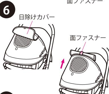
前側の日除けカバーを上部方向に巻き上げ面ファスナーで固定する。
