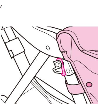
足カバー左右のベルトホックを本体フレームの外側から内側に回しホックをとめ、ゴムループを内側から外側に回しハンドルサポートに掛ける。
