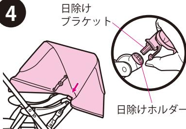
日除け左右両側の日除けブラケットを日除けホルダーに差し込み、2~3回引っ張り、確実に取り付けられていることを確認する。
