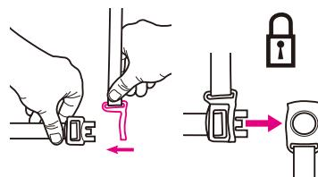
肩ベルトを腰ベルトに差し込み、腰ベルトを股バックルに差し込む。
