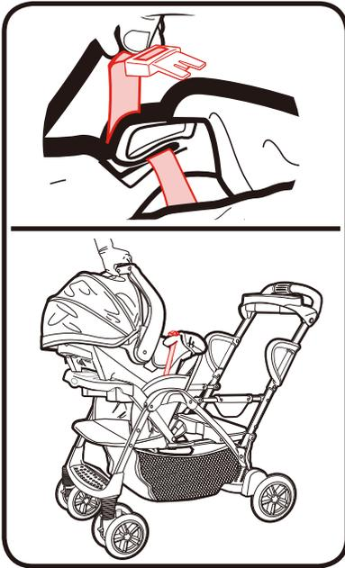
4. ベビーカーの腰ベルトを、チャイルドシート両側の車両シートベルトフックへと通す。
