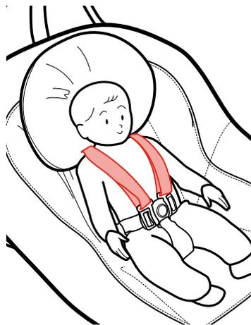
シートベルトは、肩と同じ高さか、肩の少し上の高さの通し穴に通す。シートベルトがねじれないようにしてください。
