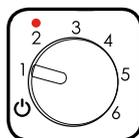
電池残量警告—スウィング速度(オフ以外)を選択すると、電池が取り付けられていれば、電池電圧が確認される。電池残量が少ないと、LEDが点滅(1秒間点灯し、1秒間消える)する。
