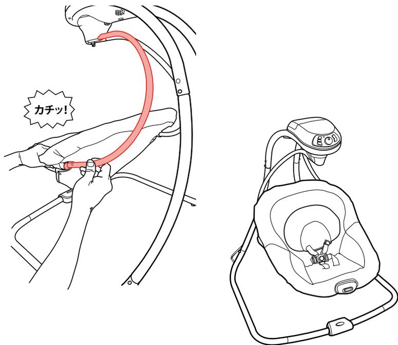
ハンガーチューブをシート側面のチューブ挿入口へ挿入する。
