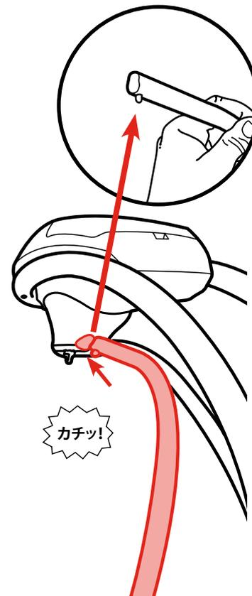
左右のハンガーチューブの長方形端部をユニットに差し込む。
