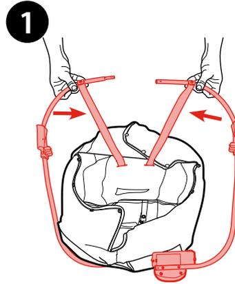
シートフレームのベルトがねじれていないか、または金属チューブに巻き付いていないか確認する。
