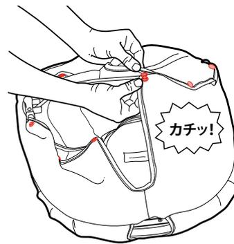
シートカバーをスナップでシートワイヤーにかぶせるようにしてとめる。
