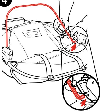
シートワイヤーを両側にある穴および溝に挿入する。
