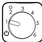
本製品の速度(1から6)を設定する。速度1では、本製品が軽くスウィングし、速度6では、可動域いっぱいまでスウィングする。
