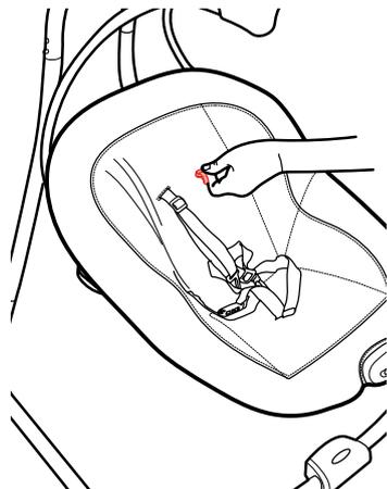
シートベルト通し穴を変更する場合、シートベルトをシートカバーの左右同じ高さの通し穴に通すようにしてください。
