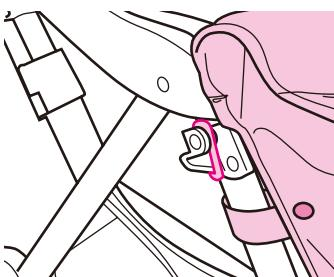
足カバー左右のベルトホックを本体フレームの外側から内側に回しホックをとめ、ゴムループを内側から外側に回しハンドルサポートに掛ける。
