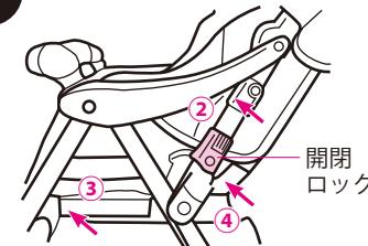
⑤ハンドルレバーロックが戻り、(青色が表示されます。)開閉ロックがロックされていることを必ず確認する。
