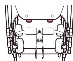
①お子さまの肩の高さに一番近いベビーカーの背もたれにある肩ベルト通し穴、シートベースの肩ベルト通し穴に、肩ベルトアンカーをひねって差し込む。
