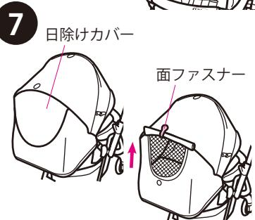
日除け左右両側の日除けブラケットを日除けホルダーに差し込み、2~3回引っ張り、確実に取り付けられていることを確認する。
