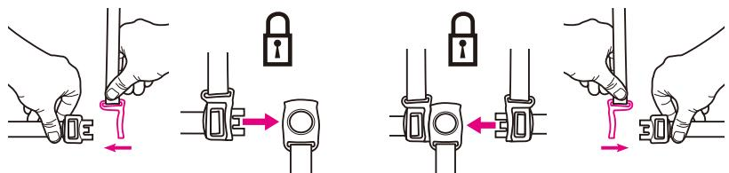
肩ベルトを腰ベルトに差し込み、腰ベルトを股バックルに差し込む。
