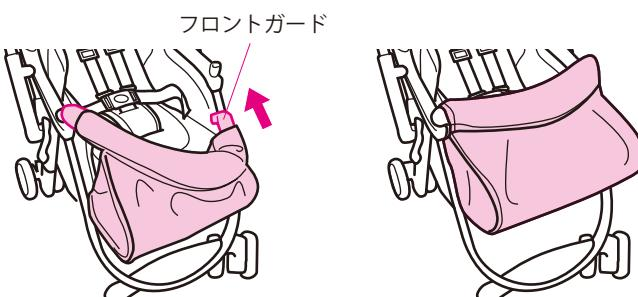
フロントガードを開いて、(P.16参照) フロントガードを足力バーの通し穴に通し、フロントガードを閉じる。
