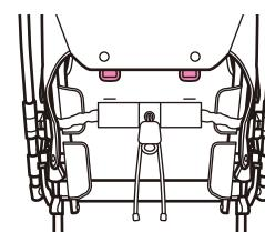
①お子さまの肩の高さに一番近いベビーカーの背もたれにある肩ベルト通し穴、シートベースの肩ベルト通し穴に、肩ベルトアンカーをひねって差し込む。
