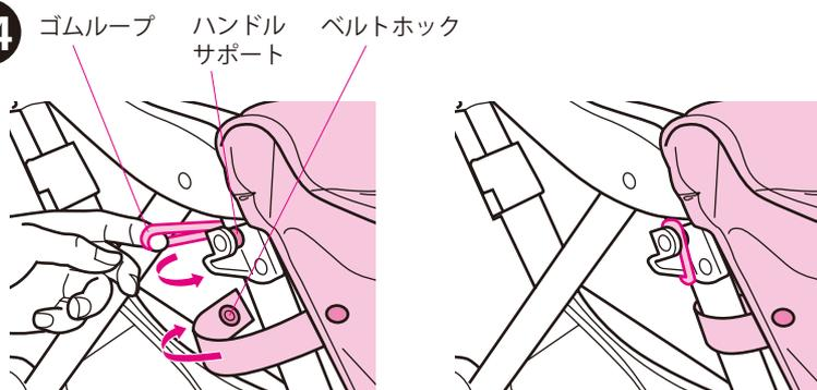
足カバー左右のベルトフックを本体フレームの外側から内側に回しフックをとめ、ゴムループを内側から外側に回しハンドルサポートに掛ける。
