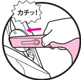
⑧フロントガードを「カチッ」と音がするまで差し込み、2~3回引っ張り、確実に取り付けられていることを確認する。
