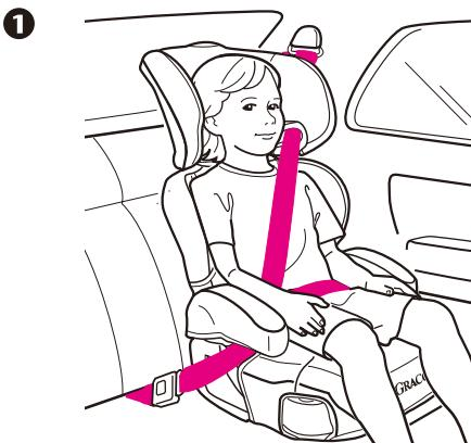
3. 図②のように、肩ベルトを肩ベルトの通し穴に通し(図③は誤った通し方です)、バックルを締め、肩ベルトを上に引っ張り、しっかりと締めます。
