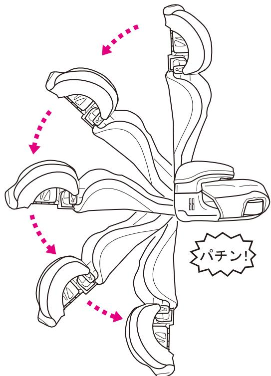
② 図のような角度で背もたれの下部にあるU字型フックをベースから外し、背もたれを矢印の方向へ取り外してください。
