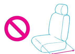
⑤座面のフラット面が極端に狭く正しく取り付けができない座席
